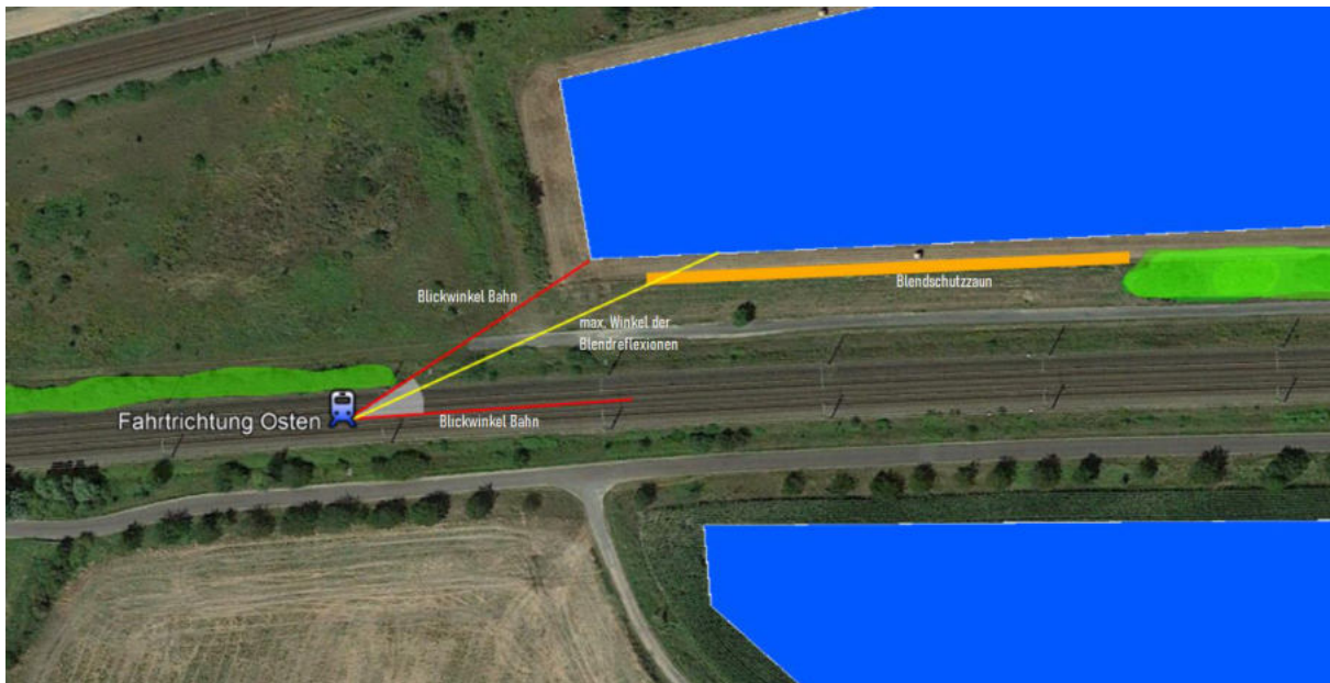
Abbildung 26: Blickwinkelberücksichtigung des Zugfahrers auf der Strecke 61805. Der natürliche Bewuchs ist grün markiert. Die roten Linien stellen den Blickwinkel ( +30^\circ ) des Zugführers dar. Durch den Bewuchs tritt die erste potenzielle Blendung an der markierten Stelle auf. Weiterhin ist der maximale Winkel der Blendreflexionen, ausgehend von dem PV-Feld, gelb dargestellt. Daraus ergibt sich die Länge des notwendigen Blendschutzzauns, orange dargestellt.
