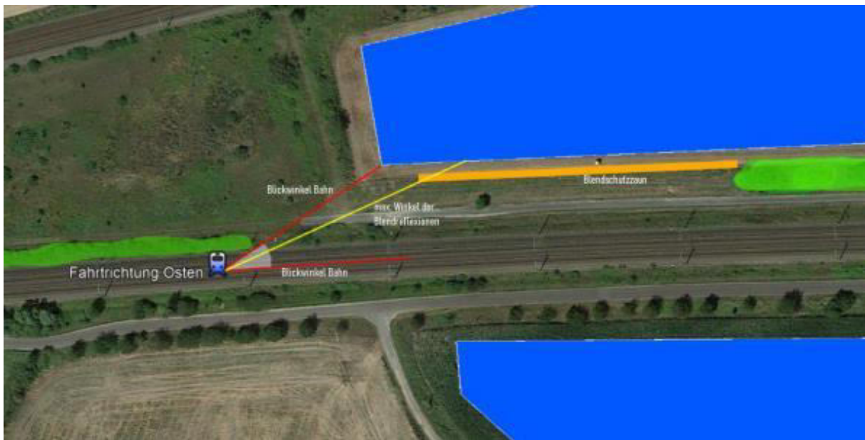
„Abbildung 26: Blickwinkelberücksichtigung des Zugfahrers auf der Strecke 6185. Der natürliche Beweuchung ist grün markiert. Die roten Linien stellen den Blickwinkel (+30°) des Zugführers dar. Durch den Beweuchung tritt die erste potenzielle Blendung an der markierten Stelle auf. Weiterhin ist der maximale Winkel der Blendreflexionen, ausgehend von dem PV-Feld, gelb dargestellt. Daraus ergibt sich die Länge des notwendigen Blendschutzzauns, orange dargestellt.“
