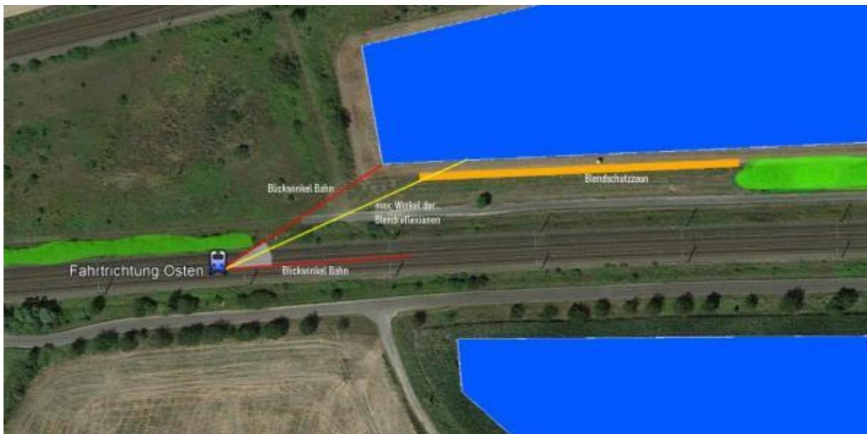
**„Abbildung 26: Blickwinkelberücksichtigung des Zugfahrers auf der Strecke 6185. Der natürliche Bewuchs ist grün markiert. Die roten Linien stellen den Blickwinkel (+30°) des Zugführers dar. Durch den Bewuchs tritt die erste potenzielle Blendung an der markierten Stelle auf. Weiterhin ist der maximale Winkel der Blendreflexionen, ausgehend von dem PV-Feld, gelb dargestellt. Daraus ergibt sich die Länge des notwendigen Blendschutzzauns, orange dargestellt.“**
