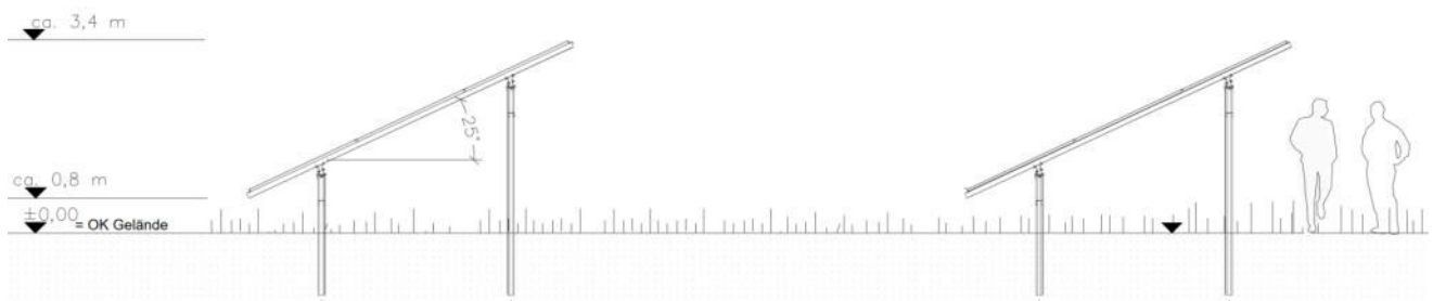
Bild 3.3.1: Skizzen der Modulkonstruktion (Quelle: Systemplanung)
