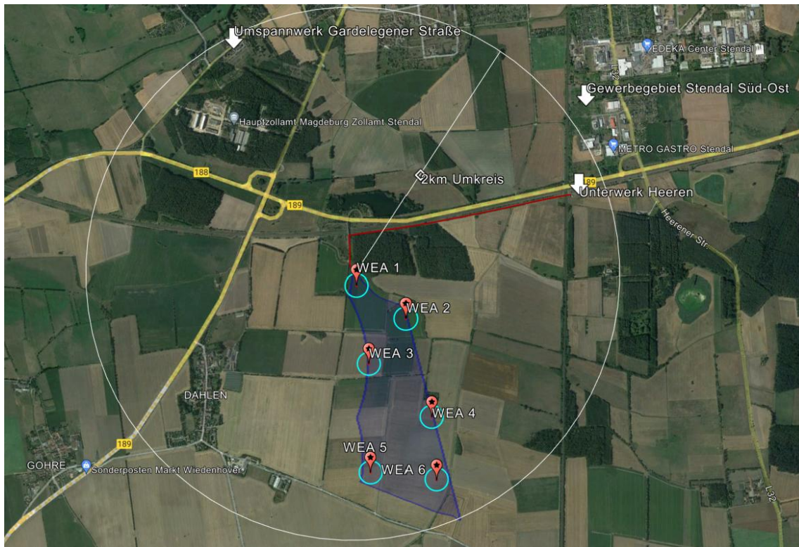
Satellitenbild mit 2 km Radius und gekennzeichneten Einspeisepunkten
