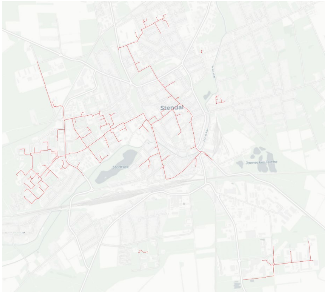
Abbildung 38 Verlauf des Bestandsfernwärmenetzes in Stendal
